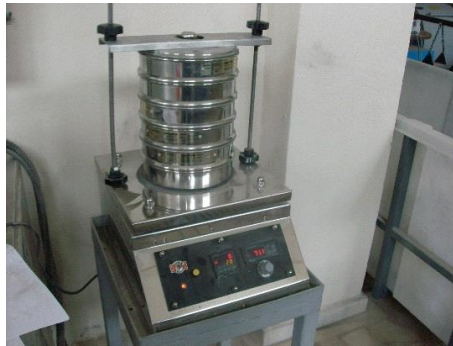
Şekil 5. Malzemenin elekte elenmesinden görünüm
