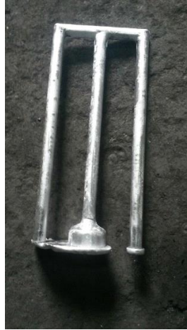
Şekil 7. Kalorifer katı atığı (kömür cürufu) kullanılarak gerçekleştirilmiş kompozit malzemedan görünüm [14].
